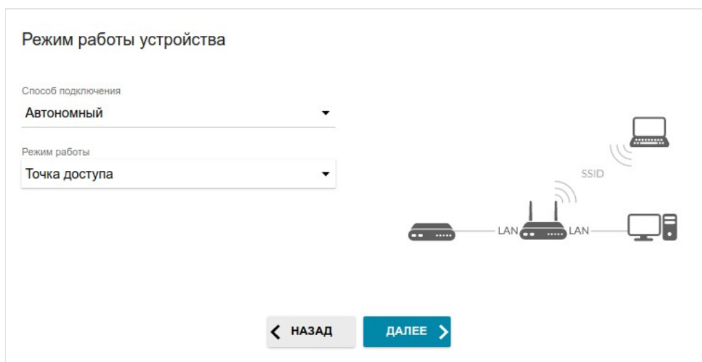
Рисунок 35. Выбор режима работы устройства. Режим Точка доступа .
