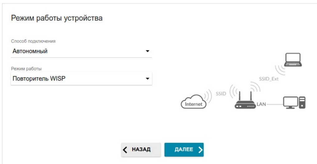
Рисунок 34. Выбор режима работы устройства. Режим Повторитель WISP .
