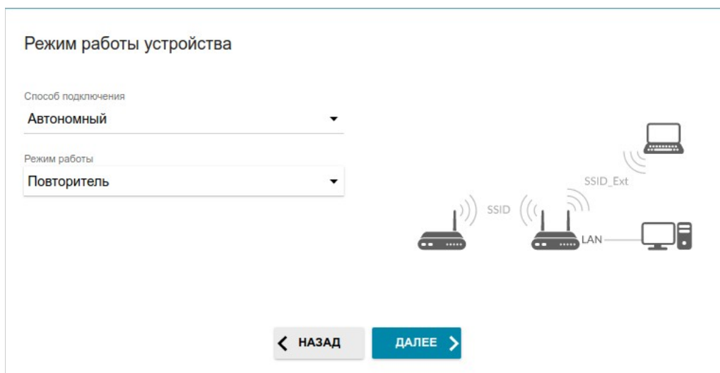
Рисунок 36. Выбор режима работы устройства. Режим Повторитель .
