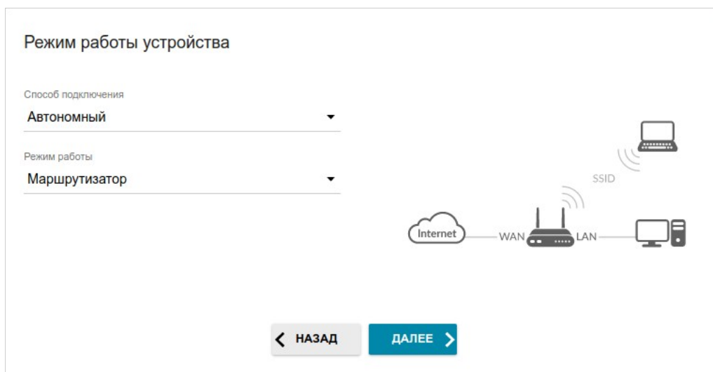
Рисунок 33. Выбор режима работы устройства. Режим Маршрутизатор .
