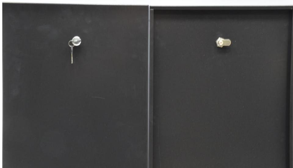
После установки передних и задних дверей фото 51 , устанавливаем в двери замки фото 46-47.
