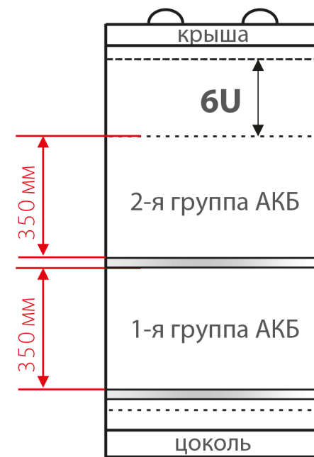
с 2 полками АКБ
