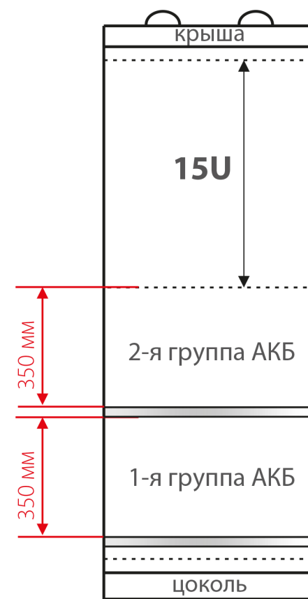
с 2 полками АКБ
