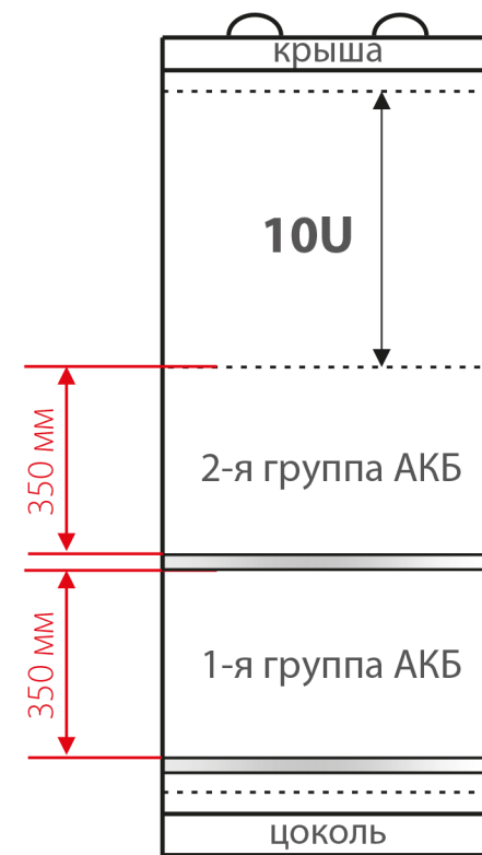
с 2 полками АКБ
